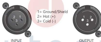
Распайка балансных разъемов XLR
