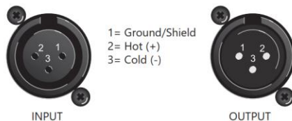
Распайка балансных разъемов XLR
